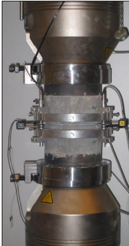
Trækprøvning før brud
